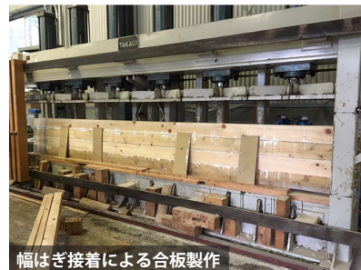
幅はぎ接着による合板製作
